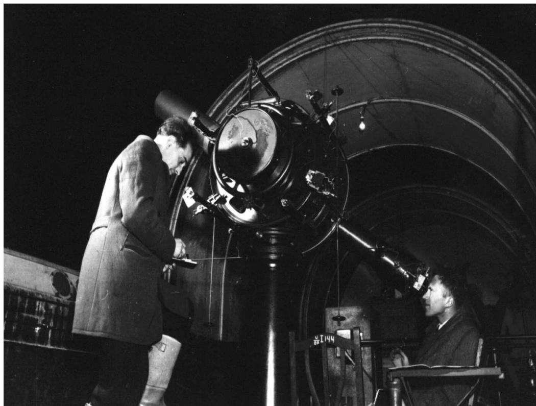
Obserwacje za pomocą koła wertykalnego Repsolda zlokalizowanego w pawilonie południkowym. Na zdjęciu widoczni są A. Głania (po lewej) i J. J. Kubikowski.
