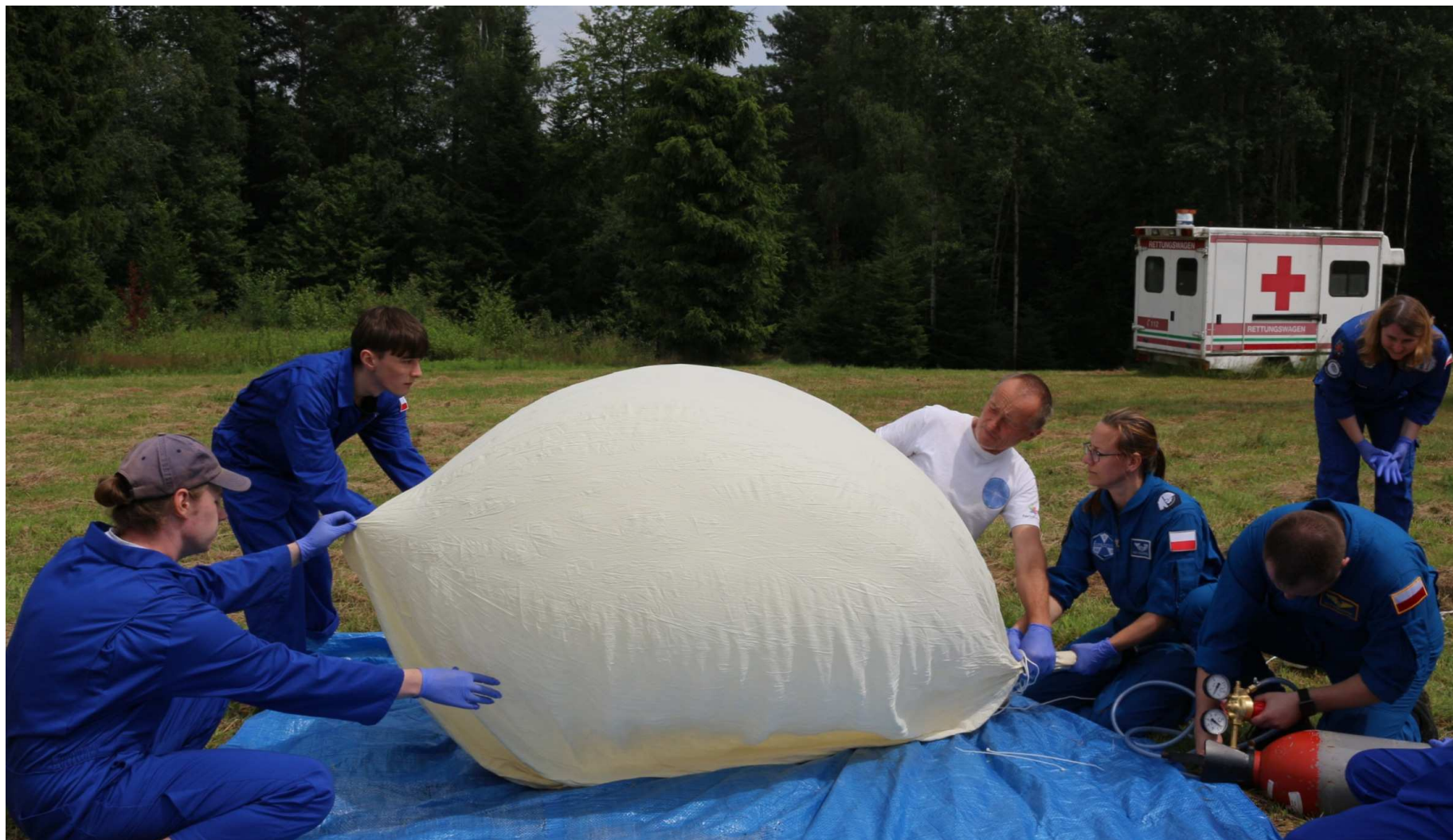
Procedura napełniania wodorem balonu stratosferycznego (18 lipca 2020, OAKJ w Rzepienniku Biskupim).
