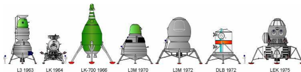
Ryc. 2.8: Różne prototypy lądowników księżycowych w ramach programu załogowego ZSRR. Źródło: Astronautics/Mark Wade [Wadb]
